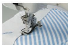
Patka se středovým vodičem
